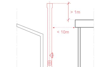
O terminal deve elevar-se pelo menos 1m acima de qualquer construção situada num raio inferior a 10m de distância à saída da chaminé.
