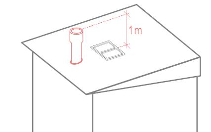
O terminal deve elevar-se pelo menos 1m acima do ponto mais elevado de qualquer abertura de ventilação ou janela existente no edifício.
