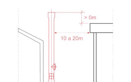
O terminal deve elevar-se acima de qualquer construção situada num raio entre 10 a 20m de distância à saída da chaminé.
