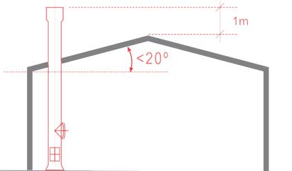
Quando a cobertura é plana ou com inclinação inferior a 20º, o terminal deve colocar-se pelo menos 1m acima do topo da mesma.
