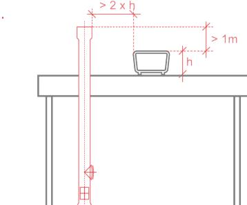
O terminal deve elevar-se o mínimo de 1m acima de qualquer obstáculo existente na cobertura do edifício e situar-se a uma distância superior a 2 vezes a altura do mesmo obstáculo.
