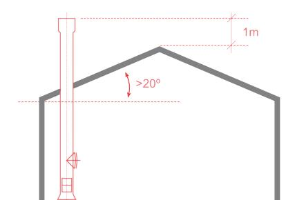
Quando a cobertura tem inclinação superior a 20º, o terminal deve colocar-se pelo menos 1m acima do topo da mesma ou a uma distância horizontal superior a 2,5m.
