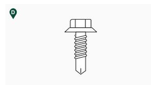
**Parafuso Autoperfurante:** Para fixar a calha aos postes e a chapa às calhas.
